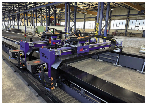
Dvojportálový stroj XS Invicta Ultimate na delenie veľkých plôch, inštalovaný u jedného zo zákazníkov DMC Slovakia.
